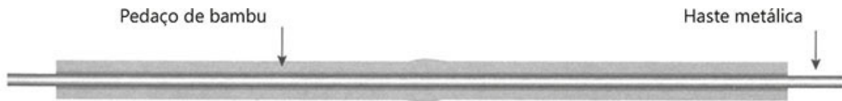
Vista transversal de um pedaço de bambu enxertado com uma haste de ferro
